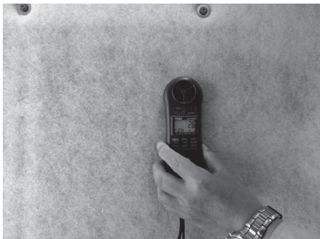
ガードのマス目最上段の風速を測定しているところだ。フィルターを巻き付ける前よりも、風速が落ちている。予想通りの結果である。
