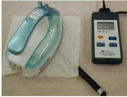
写真1 スチームアイロンによる加熱におけるカーペット表面の温度測定
