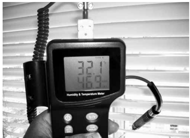
写真-2 ブラインドを閉めた裏側で測定
