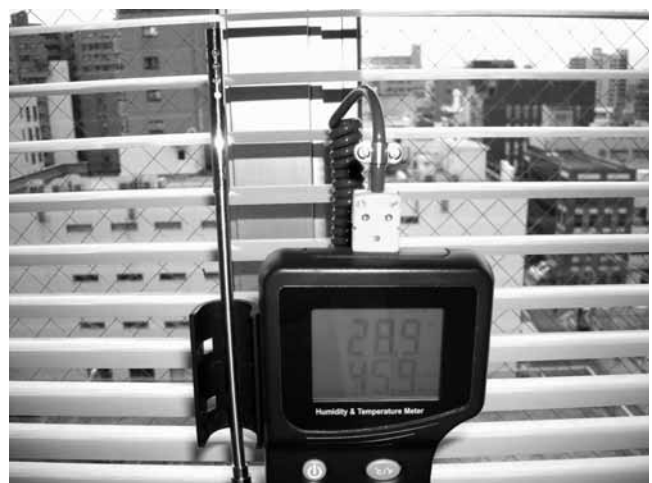
写真-3 ブラインド水平での室内側温度
