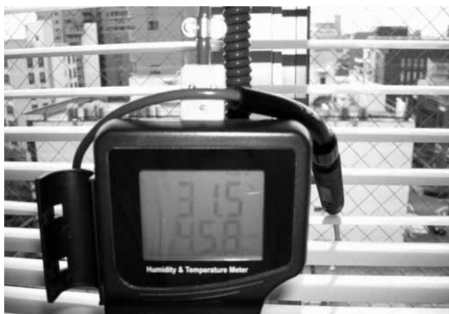
写真-4 ブラインドを水平にして窓側で測定
