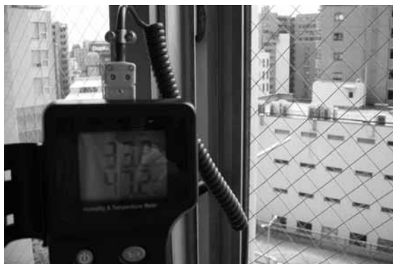
写真-6 窓の隙間から屋外を測定
